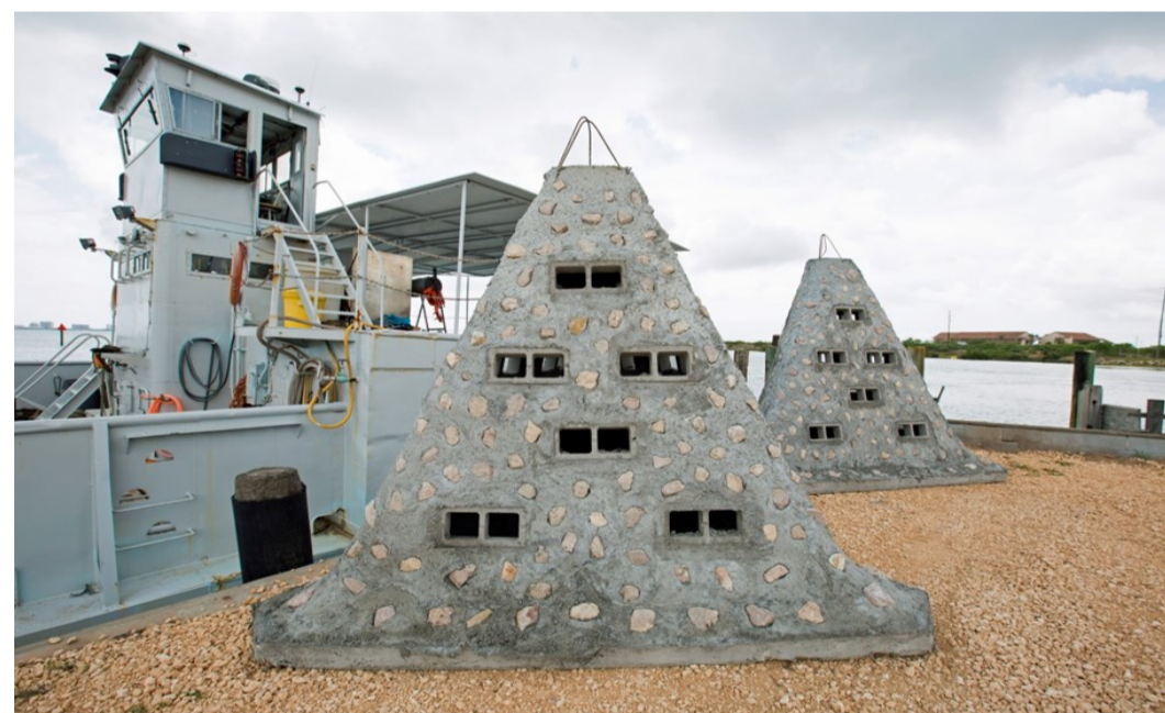
Pirámides de concreto para el RGV Reef. Fuente: Valley Business Report
